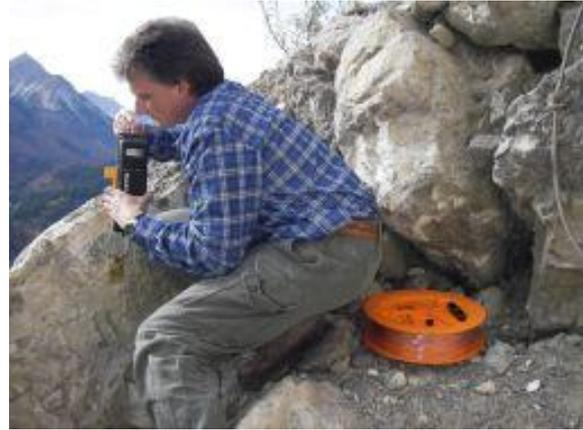
Abb.: Konvergenzmaßband (Bandextensometer) und elektronische Schlauchwaage
