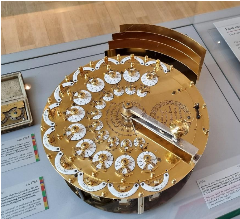
Bild 7 Vierspezies-Rechenmaschine von Pfarrer Philipp Matthäus Hahn, ca. 1774, Replik
