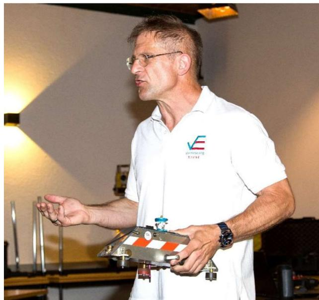
*1Mit diesem Messgerät arbeitet Erik Ernst oben auf den Kranbahnen um genaue Daten zu erfassen*
