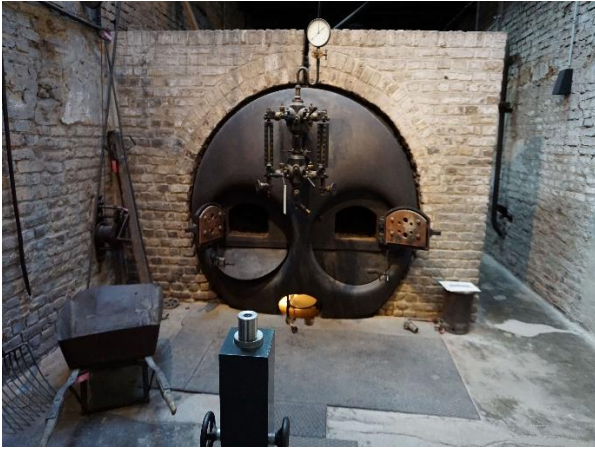
Bild 7: Der Heizkessel für die Dampfmaschine, die den Maschinenpark bewegte
