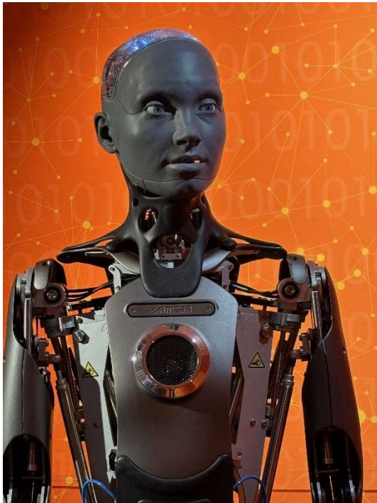
Bild 1: AMECA ist da! Wie ähnlich darf uns eine Maschine werden? Die Gesichtszüge und Bewegungen des Kommunikationsroboters wirken fast menschlich: 52 elektrische Motoren, von denen sich allein 27 im Gesicht befinden, sorgen dafür, dass AMECA den Kopf bewegen, eine menschliche Mimik zeigen, die Sprachausgabe durch passende Mundbewegungen begleiten und dazu mit Armen und Händen gestikulieren kann. (c) Monika Pitzen
