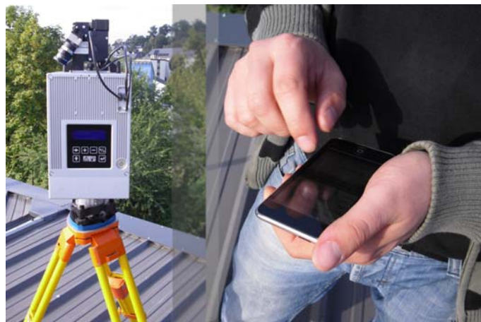
Ferngesteuerter Laserscanner via iPod touch
