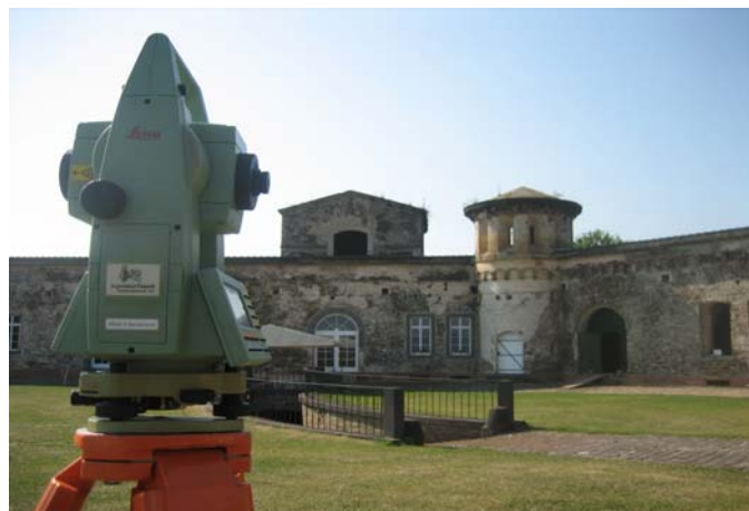
Passpunktbestimmung via Tachymetrie
