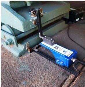
SuessCo Riss-Monitor im Praxiseinsatz, an einem Brückenlager
