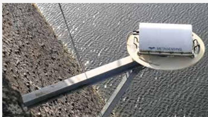
**NRW-Soest: Neuer Monitoringansatz an der Möhne-Staumauer mit neuartigen elektronischen Corner-Reflektoren (ECR)** S. XX
