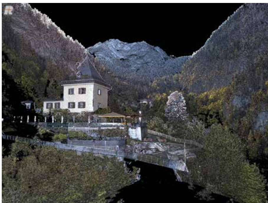
Datenerfassung mit dem RIEGL VZ-4000i-25
