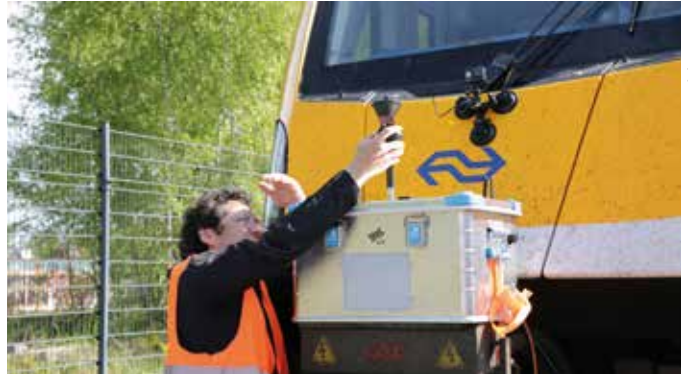
DLR-Forscher Paul Unterhuber prüft das R2DATO-System. Für die ersten Praxistests war das vom DLR entwickelte System in zwei kompakten Boxen auf den mechanischen Kupplungen an den Zugnasen befestigt.
