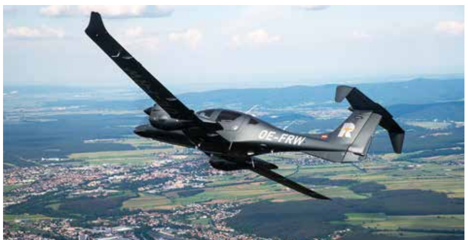
RIEGL-Messflugzeug mit integriertem RIEGL-VQ-840-GE-System
